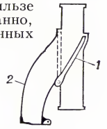
Рис. 5. Стрелка с приёмным устройством: 1 — стрелка; 2 — приёмное устройство.
